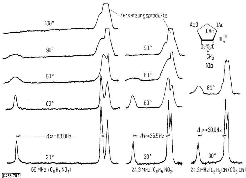
Ausschnitte aus den temperaturabhängigen NMR-Spektren des Acetoxonium-Salzes **10b** (nur Methyl-Signale).
