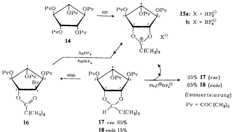
und dem Pivaloxonium-Ion **15b** besteht, wurde **17** + **18** zusammen mit einem großen Überschuß von 2-tert.-Butyl-1.3-dioxolan-ylum-(2)-SbCl<sub>6</sub><sup>14)</sup> in CD<sub>3</sub>CN gelöst. Auch hierbei trat nur schnelle *exo-endo*-Isomerisierung von **17** + **18** ein. Eine einfache Erklärung dieser Befunde konnte bisher nicht gegeben werden.
